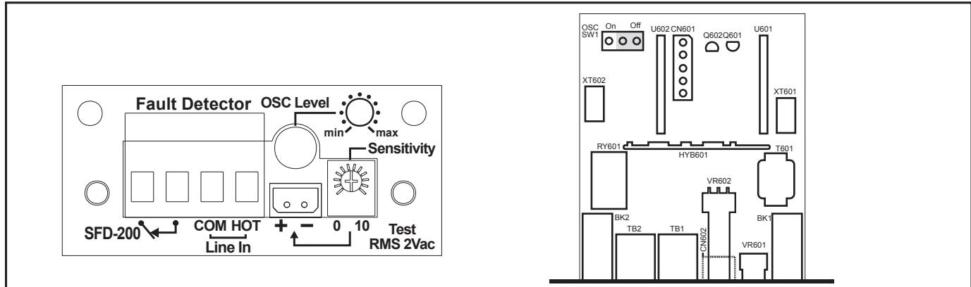
Данный модуль определяет неисправность (КЗ и обрыв) трансляционной линии путем подачи в нее синусоидального сигнала частотой 20кГц и напряжением 2В (для 70 или 100В линии). Этот сигнал поступает в трансляционную линию вместе со звуковым сигналом и, проходя через нее, возвращается к модулю по обратному кабелю. Специальный фильтр выделяет только сигнал проверки 20кГц и детектор определяет состояние трансляционной линии.
