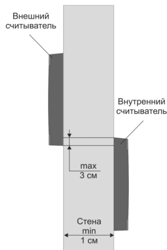
Рисунок 7. Крепление считывателей с разнесением по вертикали
