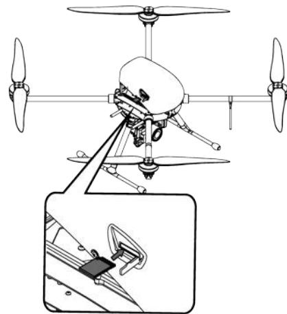
Установка карты памяти GNSS-приемника в слот БВС (комплектация со встроенным приемником)
