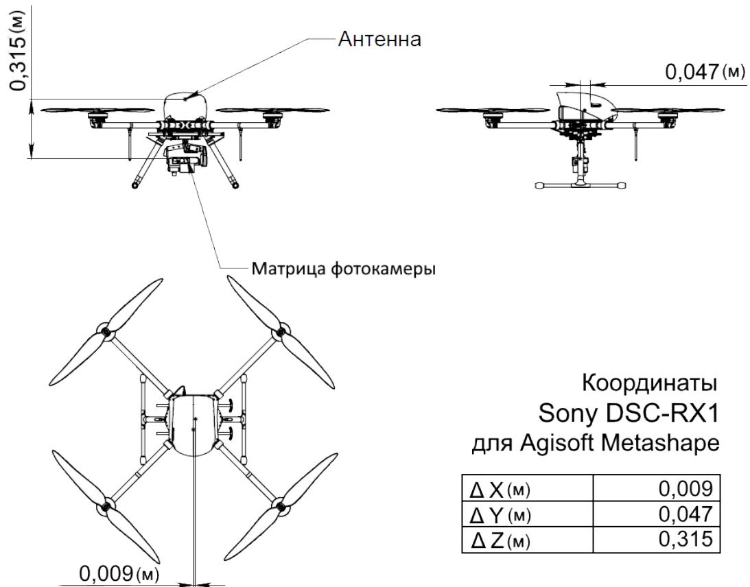
Координаты фазового центра GNSS-приемника относительно центральной точки объектива камеры
