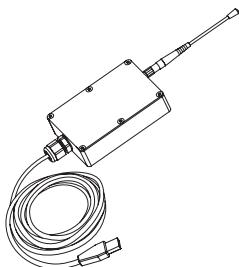
Радиомодем позволяет загружать полетное задание в память автопилота, осуществлять настройку БВС и ручное управление полетом с помощью ПО Geoscan Planner. Для подключения БВС требуется предварительная настройка сети, которая описывается в данном разделе.
