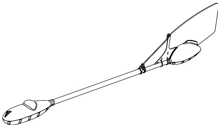
Подвесной квантовый магнитометр с рубидиевым датчиком разработан для проведения аэромагнитной съемки на предельно малых высотах с детальным огибанием рельефа.
