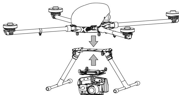
Пример установки квадрокоптера и подвеса камеры на шасси
