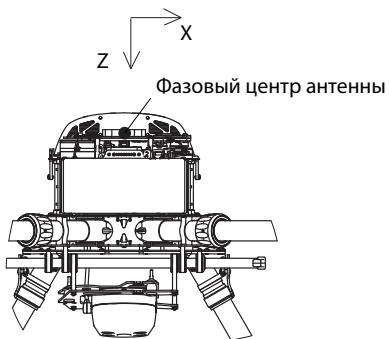
Фазовый центр антенны бортового GNSS-приемника БВС имеет смещение относительно центров фотографирования матриц камеры Pollux. Координаты смещений следует учитывать при обработке снимков с помощью фотограмметрического ПО Agisoft Metashape или аналогичного.
