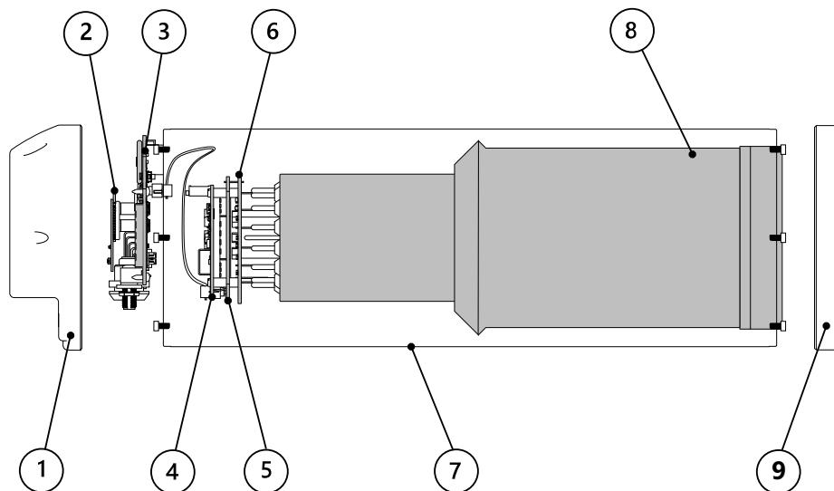
Конструктивная схема гамма-спектрометра показана на рисунке. Корпус (7) изготовлен из углепластика. Внутри размещен сцинтиллятор (8) с ФЭУ и платы управления устройством и фиксации измерений. С тыльной стороны цилиндра располагается алюминиевая крышка (9). С передней стороны расположена пластиковая крышка (1) с платой обработки и хранения данных (3) сцинтиллятора. На внешней стороне крышки размещены индикаторы работы устройства, кнопка управления записью и разъемы.
