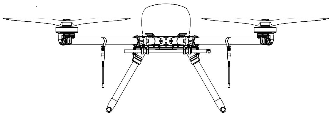
Геоскан 401 – многоцелевой комплекс, включающий беспилотное воздушное судно мультироторного типа со сменной полезной нагрузкой и ПО планирования полетных заданий.
