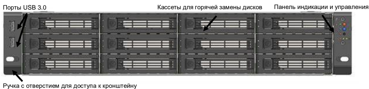
Рисунок 2. Передняя панель корпуса
