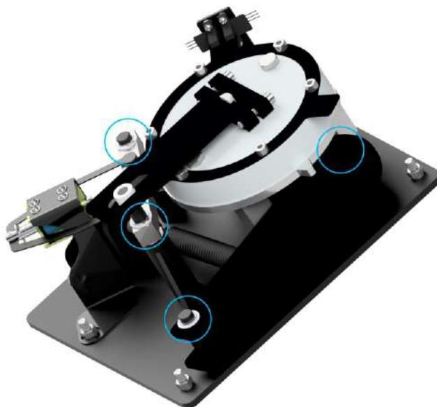
Рисунок 12.5.1 – Места смазки подвижных частей
