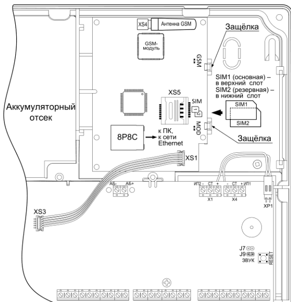
Рис.1 Установка коммуникатора в прибор.
