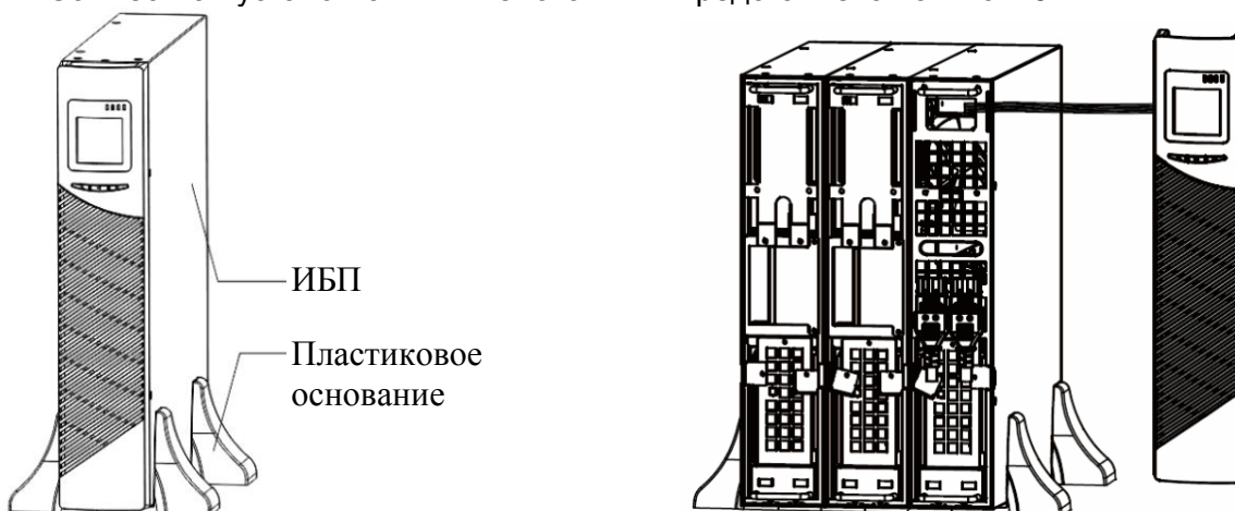
Рис.16 Установка ИБП и внешних аккумуляторных блоков
