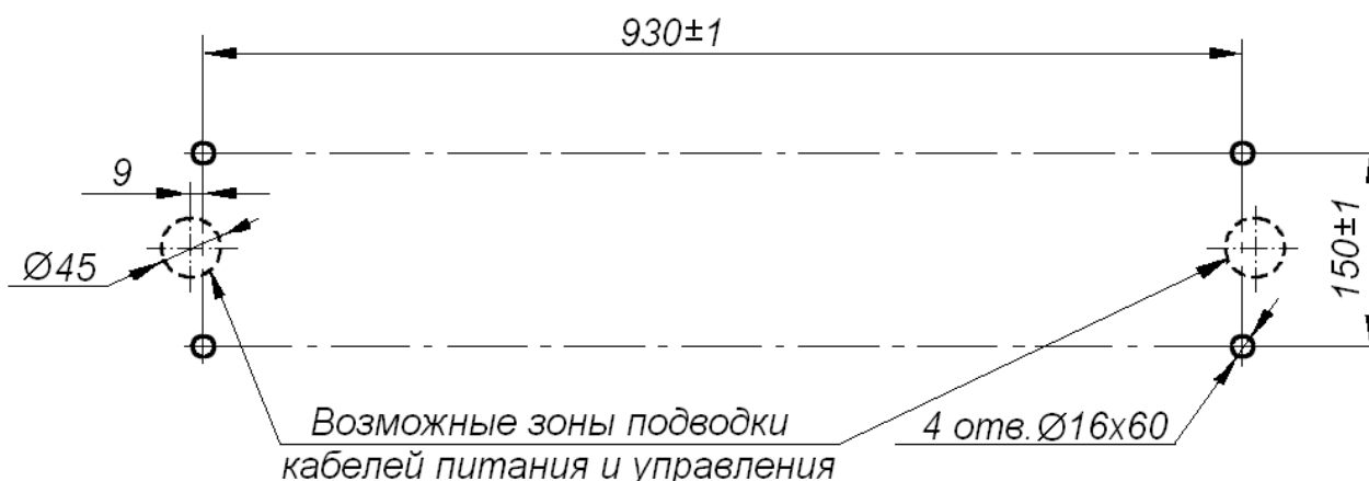
Рисунок 11. Схема разметки отверстий для крепления стойки турникета 1
