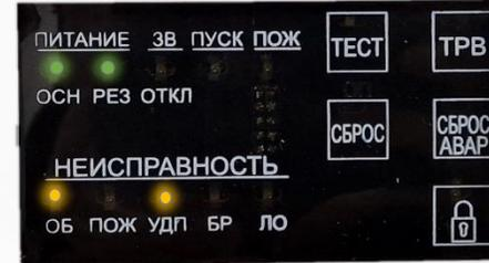
Индикаторы «ОСН», «РЕЗ» и «ОБ» и «БР» горят ровным свечением. Звуковой сигнализатор выдает непрерывный сигнал - **Обрыв, короткое замыкание или неправильно установленные оконечные резисторы (установить согласно схеме,) в линии «БР»**
