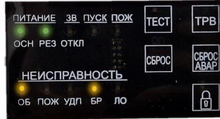
Индикаторы «ОСН», «РЕЗ» и «ОБ» и «ЛО» горят ровным свечением. Звуковой сигнализатор выдает непрерывный сигнал - **Обрыв, короткое замыкание или неправильно установленные оконечные резисторы (установить согласно схеме) в линии «ЛО»** так же динамики должны быть с буквой Л,
