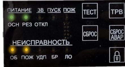
Индикаторы «ОСН», «РЕЗ» и «ОБ» и «УДП» горят ровным свечением. Звуковой сигнализатор выдает непрерывный сигнал - **Обрыв, короткое замыкание или неправильно установленные оконечные резисторы (установить согласно схеме, 2шт. последовательно) в линии «УДП»**
