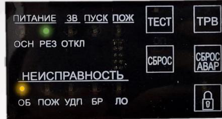
Световые индикаторы «ОСН» и «ОБ» горят ровным свечением. Звуковой сигнализатор выдает непрерывный сигнал – **отсутствует резервное питание (АКБ)**
