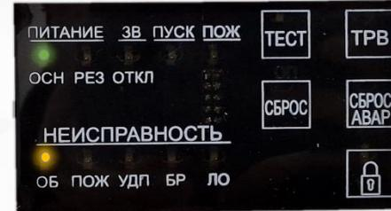
Индикаторы «ОСН», «РЕЗ» и «ОБ» и «ПОЖ» горят ровным свечением. Звуковой сигнализатор выдает непрерывный сигнал - **Обрыв, короткое замыкание или неправильно установленные оконечные резисторы (установить согласно схеме, 2шт. последовательно) в линии «ПОЖ»**
