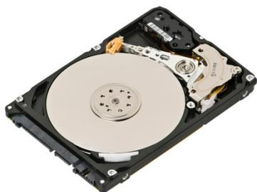
Жесткий магнитный диск - носитель данных в виде тонкого диска из немагнитного материала (обычно из алюминия, стекла или керамики), покрытого с одной или двух сторон слоем ферромагнетика. **Ферромагнетик** - вещество, способное намагничиваться, то есть под воздействием внешнего магнитного поля изменять уровень остаточной намагниченности. Это свойство используется для записи единиц информации (упрощенно 1 – намагничено, 0 – размагничено) на поверхность диска при помощи магнитных головок.
