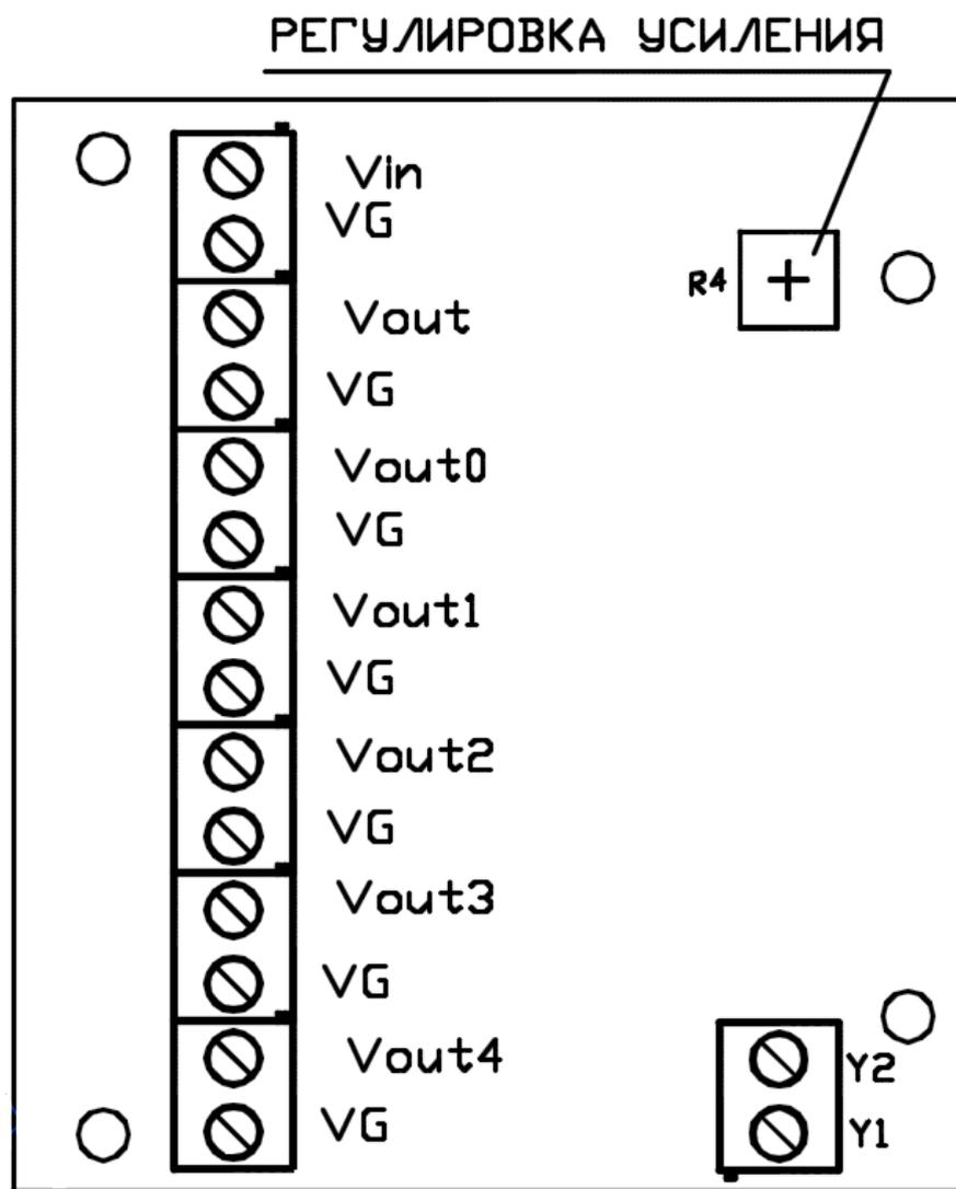
Рис. 2 Вид платы видеоразветвителя.
