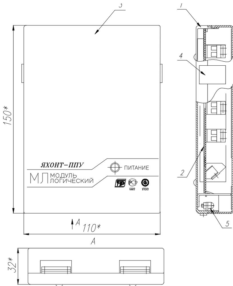
Рис.А.4 Габаритные размеры и устройство МЛ.
