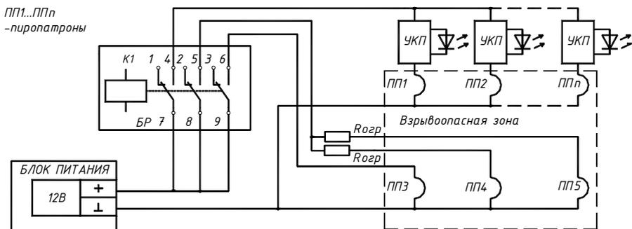
Рис. 2.18 Пример подключения пиропатронов к БР
