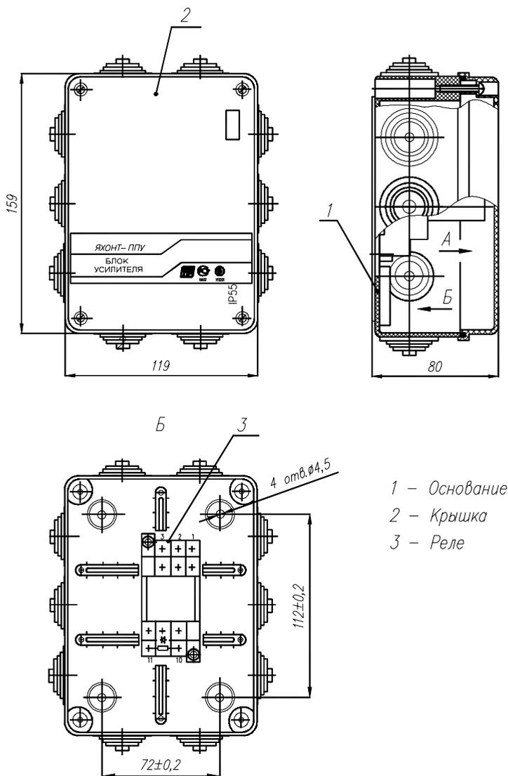
Рис.А.6 Габаритные размеры и устройство БУ.
