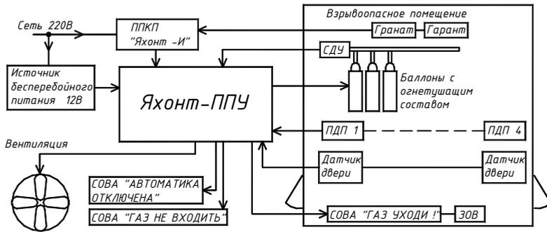
Рис.1.1.1. Пример организации автоматического пожаротушения взрывоопасного помещения.
